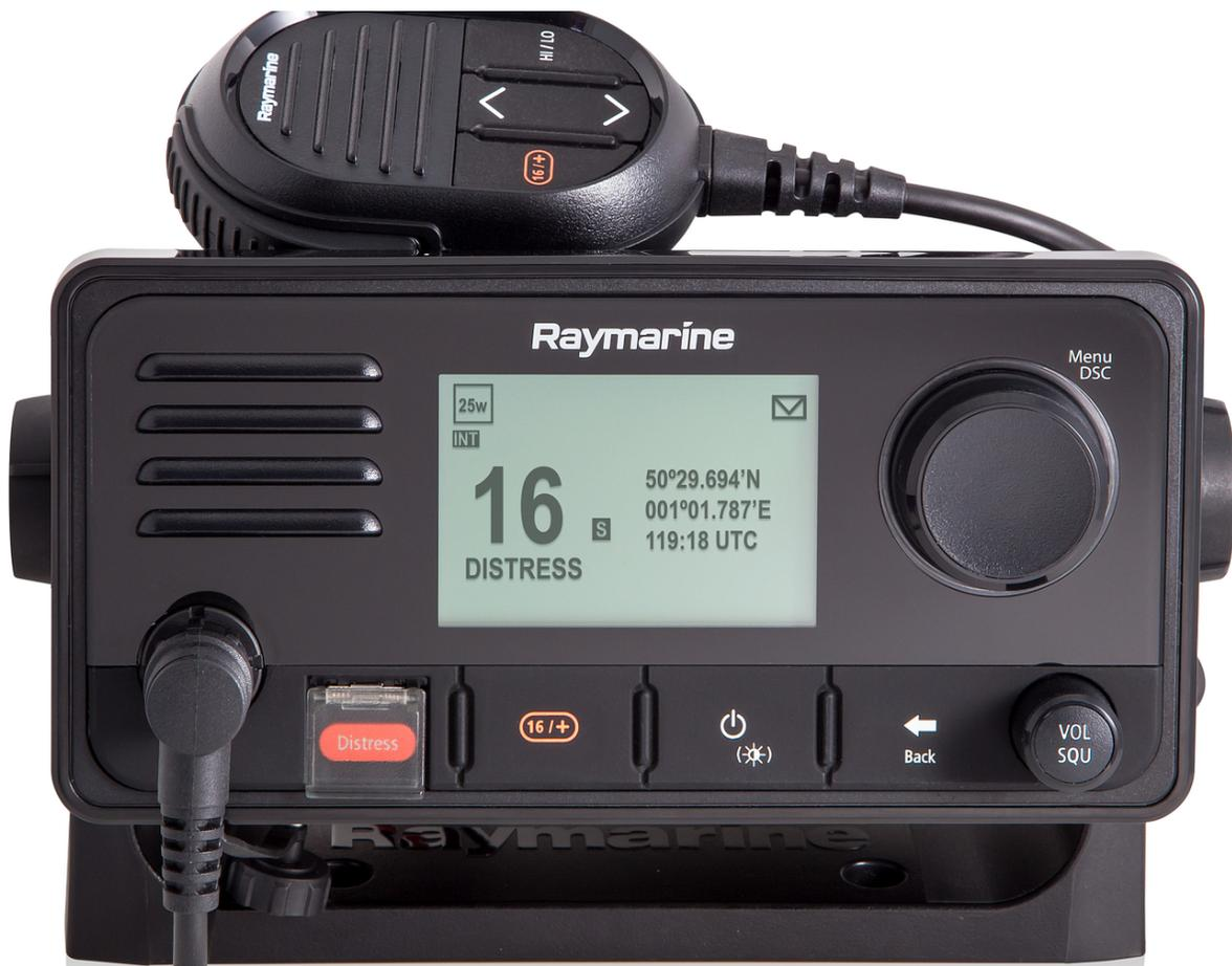
I modelli Ray53 compatto, Ray63 standard, Ray73 multifunzione con AIS sono tutte radio VHF marine dotate di funzionalità complete e chiamata selettiva digitale in Classe D (DSC).
